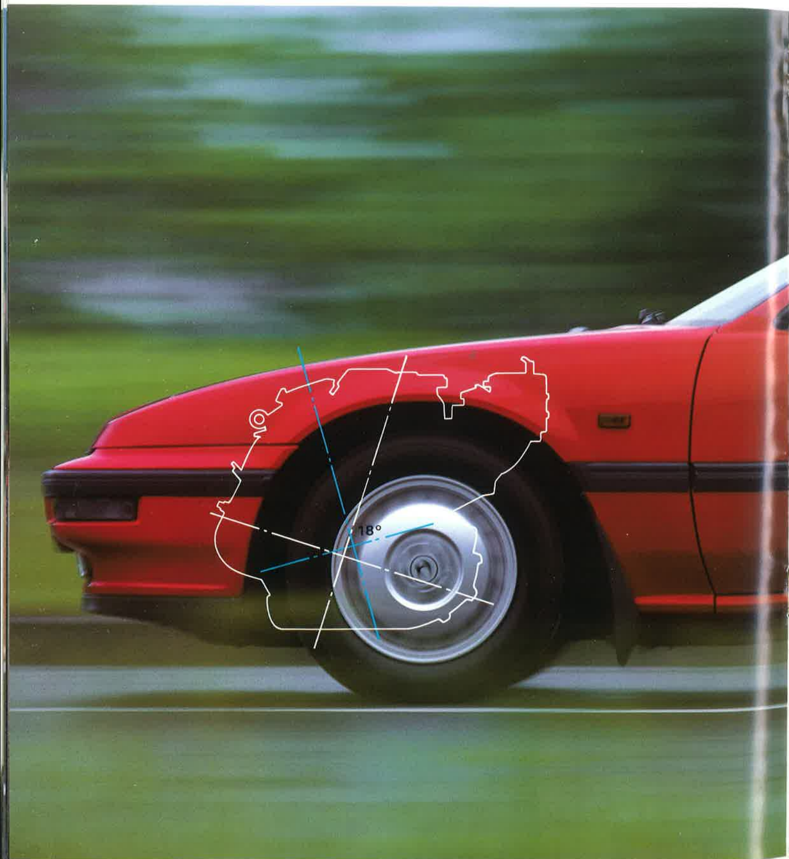
Moteur transversal incliné à 18° vers l'arrière
