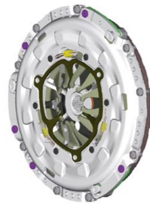
Embrayage composé du plateau de pression et du disque d'embrayage
