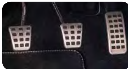
▲ Kit pédalier sport Aluminium brossé. Aucun perçage nécessaire. MZ313904
