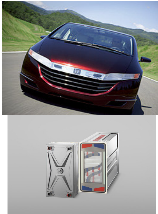
Figure 9 – La FCX 2006 et sa pile à combustible
