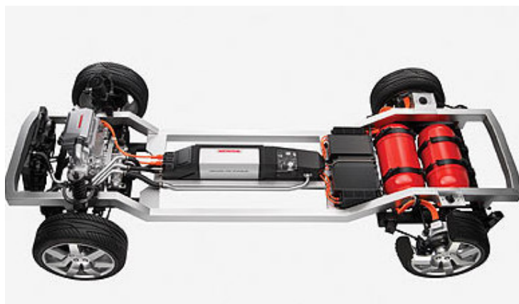
Figure 8 – Vue éclatée de la Honda FCX 2006
