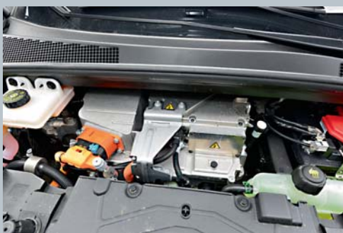
MADE IN FRANCE | Le moteur électrique synchrone à rotor bobiné est construit sur le site de Cléon.
