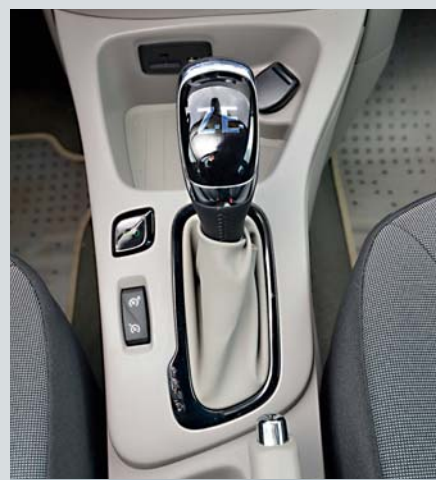
SANS VITESSE | Il n'y a pas de boîte de vitesses sur la Zoé. Mais ça ne change pas grand-chose à l'affaire, le sélecteur de boîte étant analogue à celui d'une classique boîte automatique.
