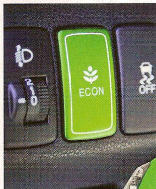
Le bouton «Econ» : optimiser les économies de carburant en modifiant la gestion du moteur et de la boîte.
