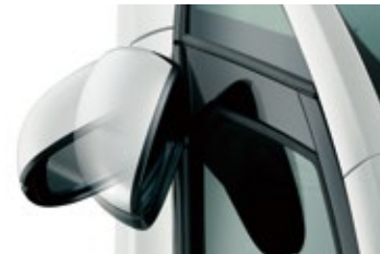
10. オートリトラミラー ドアロック運動タイプ ミラーをドアロックで格納、 アンロックで展開。 ¥11,000 (消費税10%抜き ¥10,000) [1.2H] ※写真は説明のためのイメージです。 ▶ P.32
