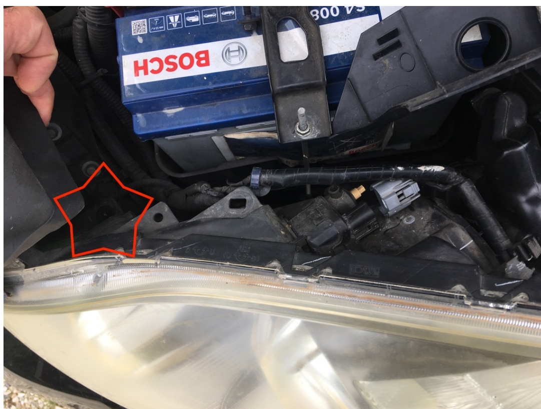
Vis de fixation de logique et une autre a cotés du Klaxon
