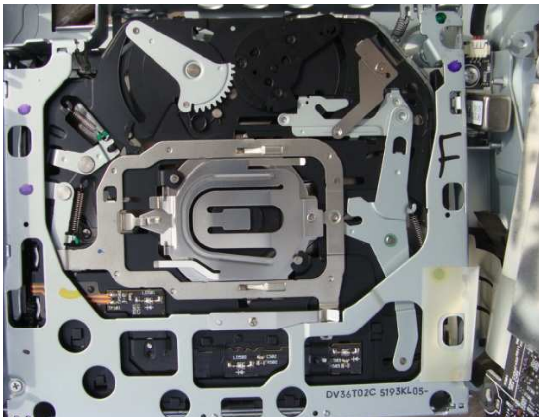
CECI EST le lecteur DVD du GPS côté pile, sous la partie électronique (que l'on aperçoit basculée à droite de la photo).
