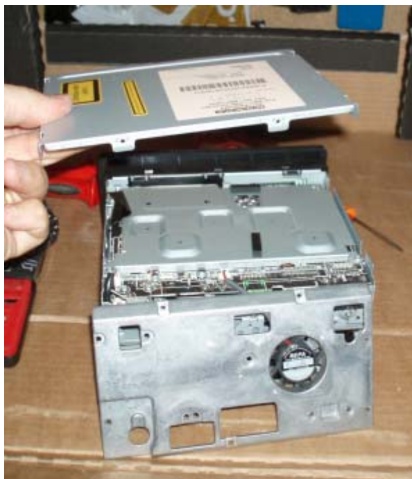
Démontage des plaques arrière et supérieure. Vue de l'arrière.
