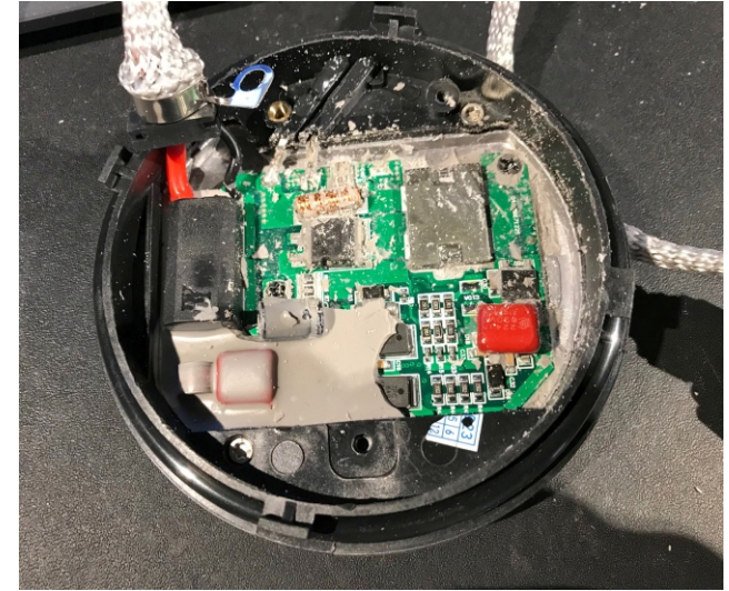
Enlever le silicone avec un tournevis
