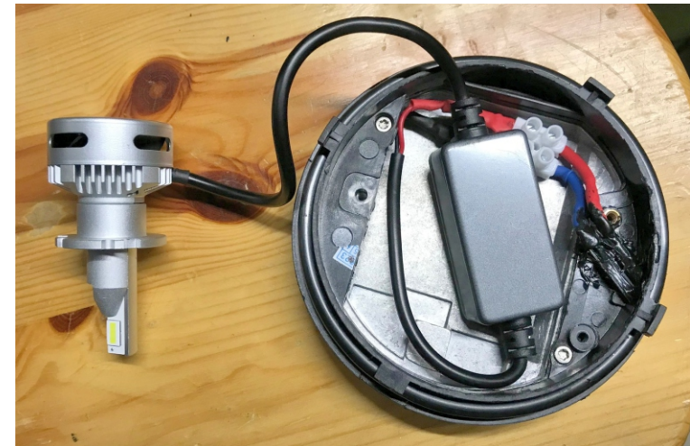
La LED et son alimentation connectées au couvercle
