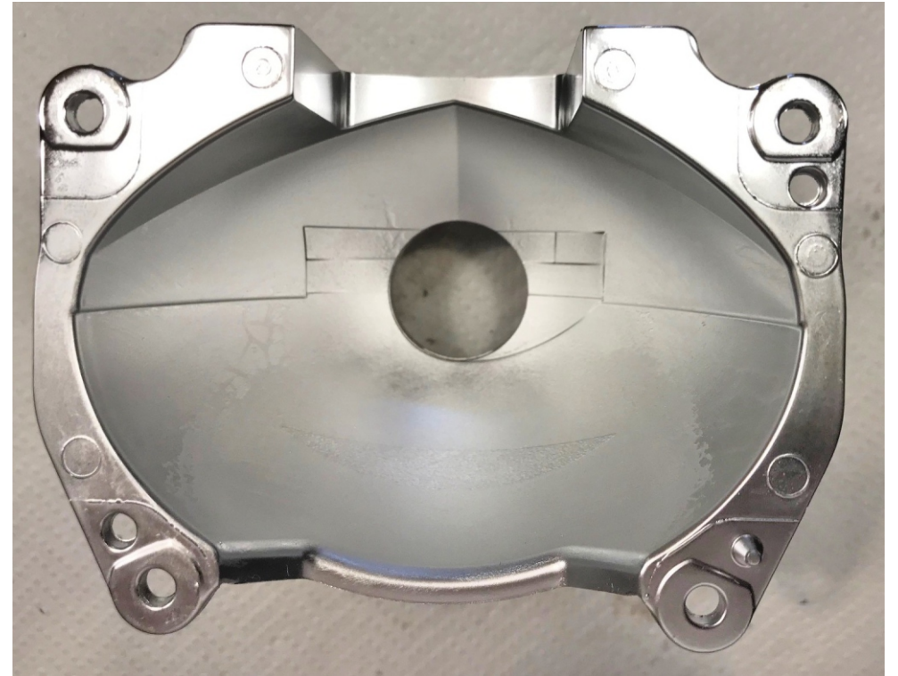
Après ponçage et peinture métallisée dite «chrome»
