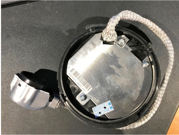
Avant démontage. Le module possède un grand O-ring d'étanchéité sur le pourtour
