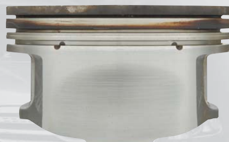
Piston après l'essai moteur Sequence IIIG de double durée
