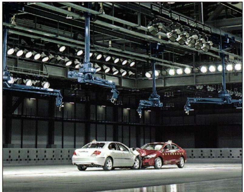
Dans le centre de recherches et de développement Honda à Tochigi, le plus grand et le plus moderne du monde, nous réalisons des crash-tests afin de construire nos véhicules avec un maximum de sécurité. C'est ainsi qu'a été conçu la carrosserie spécifique ACE permettant de dévier l'énergie d'un impact de la cabine via les flancs de la carrosserie.
