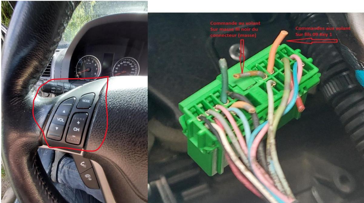
Depuis les fils du connecteur 20 pins en provenance du faisceau de la CRV a branché sur le connecteur de la radio via l'adaptateur
