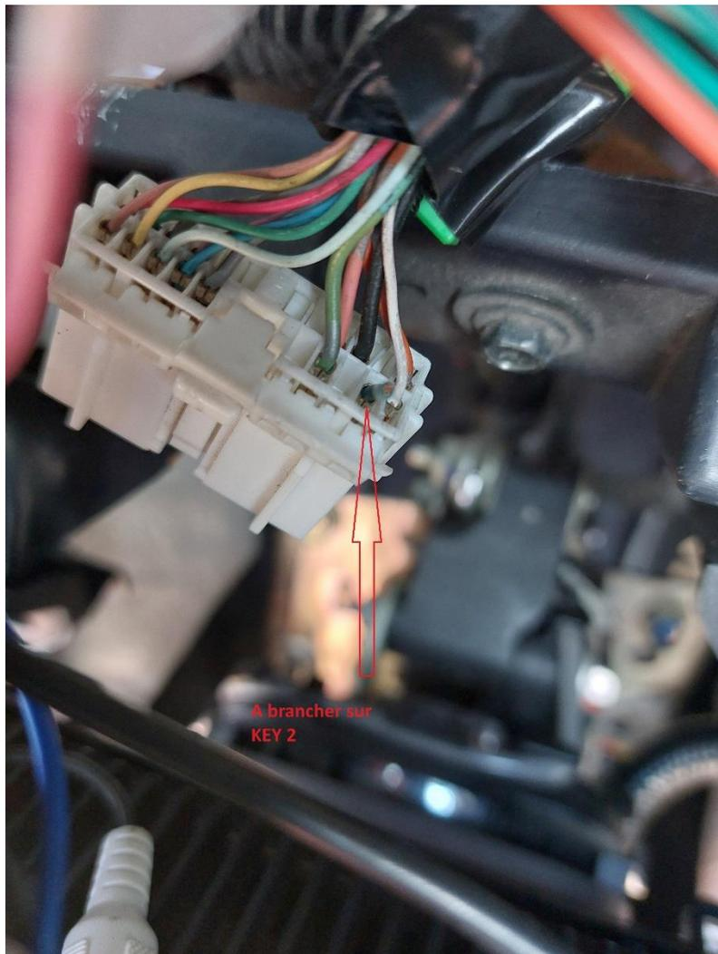
Pour être sûr d'avoir les bons fils, brancher un Ohms mètre entre le fils et sur Pin 6 masse en appuyant sur les boutons de la commande vous devez avoir des valeurs Ohmiques (résistance) différentes
