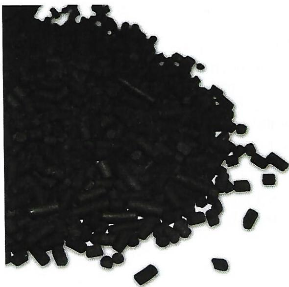
Concrètement, le filtre canister est composé de ces petits granulés. Il n'y a pas d'entretien préconisé et sont censés durer toute la vie du véhicule dans un cas de fonctionnement normal. En revanche, si le canister se retrouve dans du carburant, lié à un clapet fuyant par exemple, celui-ci ne pourra plus traiter efficacement les vapeurs d'essence et il faut le remplacer.
